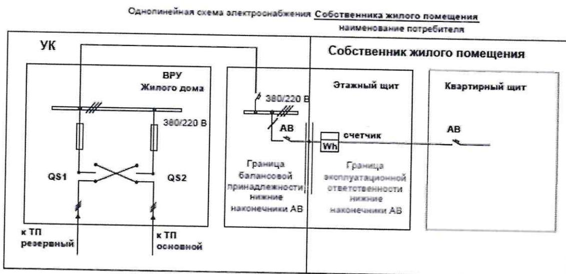
2. Граница балансовой принадлежности электроустановки: отходящая кабельная линия от нижних наконечников автоматического выключателя в этажном щите к Собственнику Жилого помещения, счетчик электрической энергии в этажном щите, отходящая кабельная линия от счетчика электроэнергии в этажном щите до квартирного щита.
